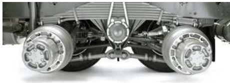
Slika 10: Trapezno vzmetenje Vir: Volvo FM suspension
