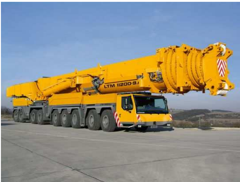
Slika 42: mobilno dvigalo Liebherr 11200-9.1 nosilnosti 1200 ton Vir: www.vertikal.net
