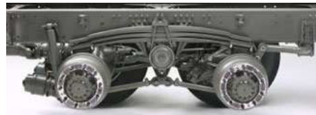
Slika 11: Parabolično vzmetenje Vir: Volvo FH16 suspension
