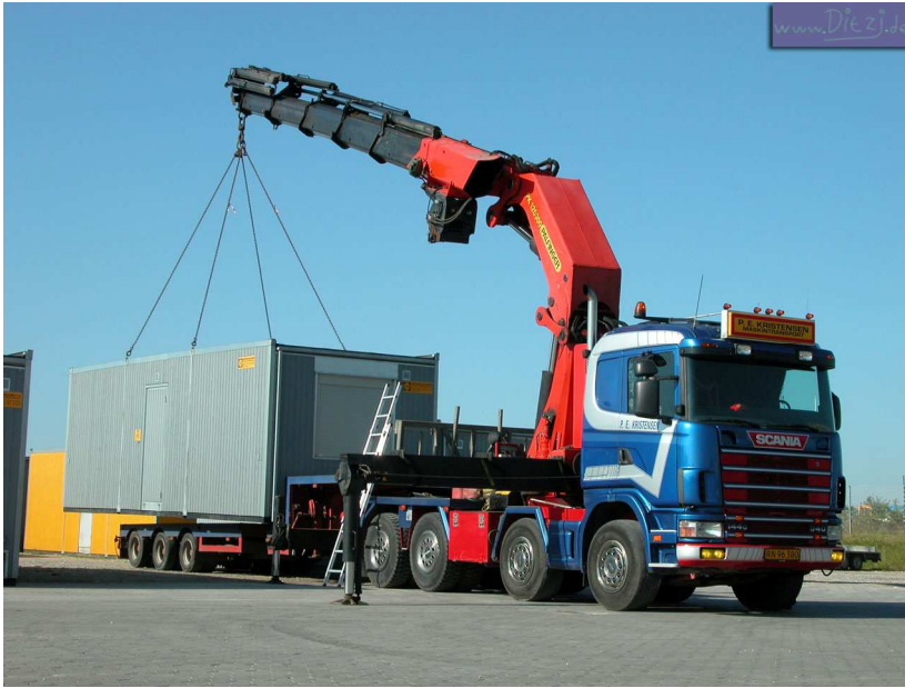
Slika 41: konzolno dvigalo Palfinger PK 120000 G Vir: www.ditzj.de
