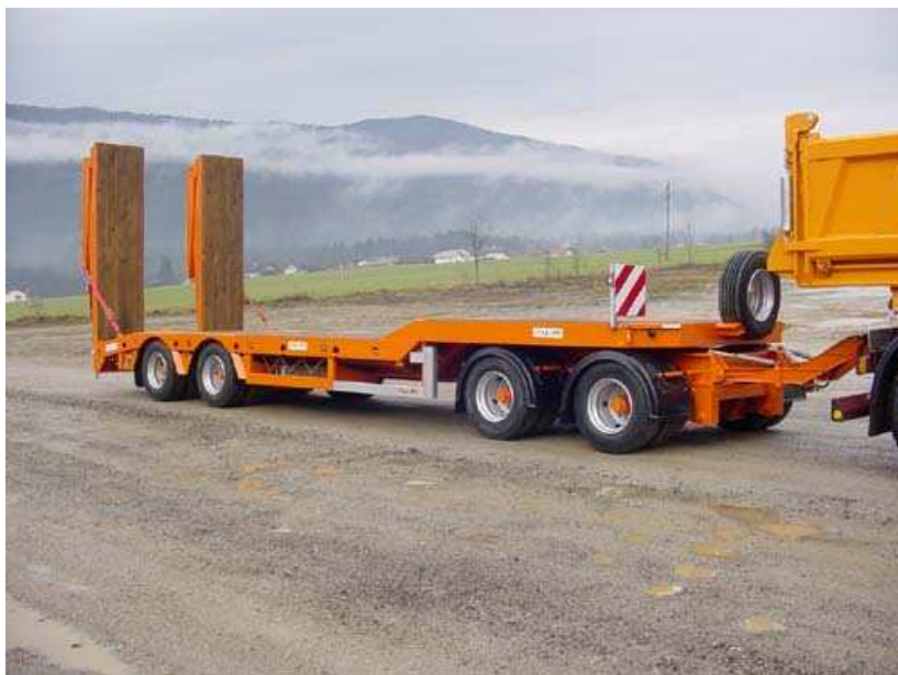
Slika 13: Nizkotovorni priklopnik za prevoz gradbene mehanizacije Vir: ITAS – PTI d. o. o.
