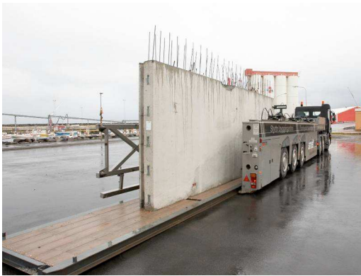
Slika 30: specialna polprikolica za prevoz ozkih elementov Vir: www.langendorf.de
