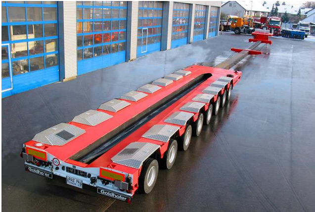
Slika 29: specialna polprikolica za prevoz dolgih tovorov Vir: www.goldhofer.de
