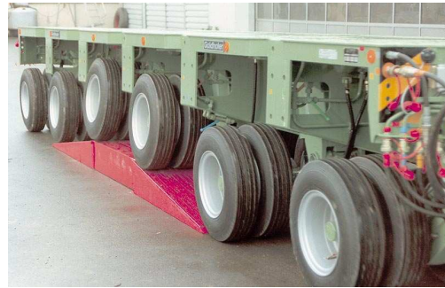
Slika 19: Delovanje izravnavanja pritiska Vir: www.goldhofer.de
