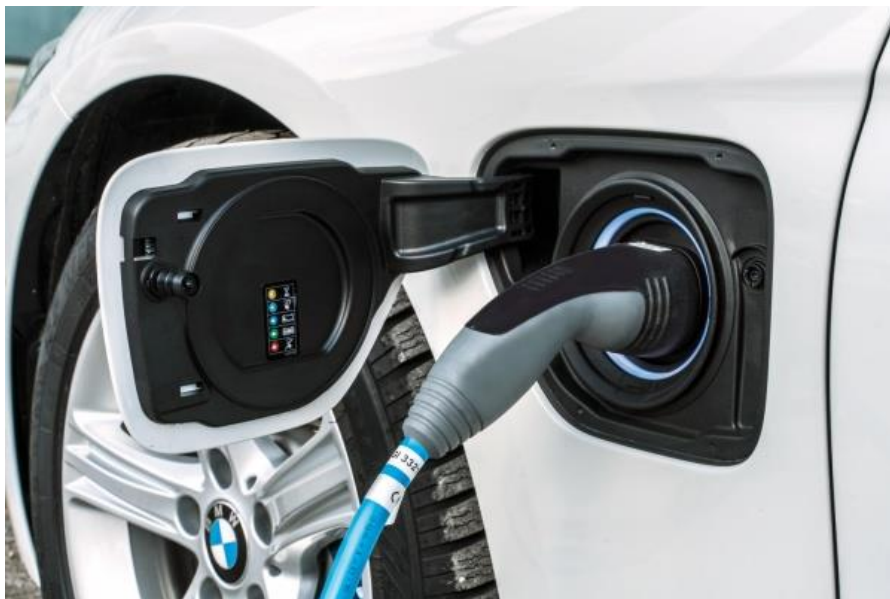
Slika 2: Primer konduktivnega polnjenja (Vir: Monitor.si, 2016)
