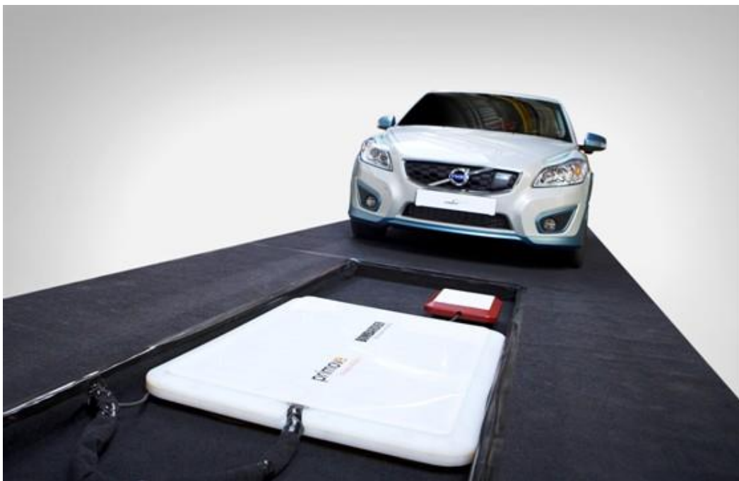
Slika 3: Primer induktivnega polnjenja (Vir: Avto.over.net, 2013)
