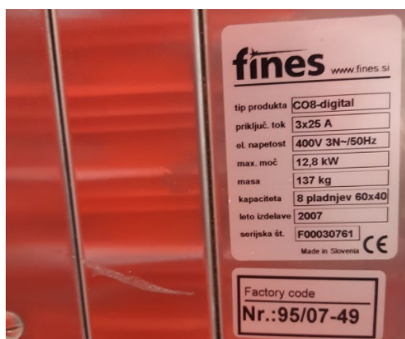
Slika 6: Ploščica s tehničnimi podatki obstoječe konvekcijske peči CO8-digital na Domačiji Karlovski mlin (Lastni vir)
