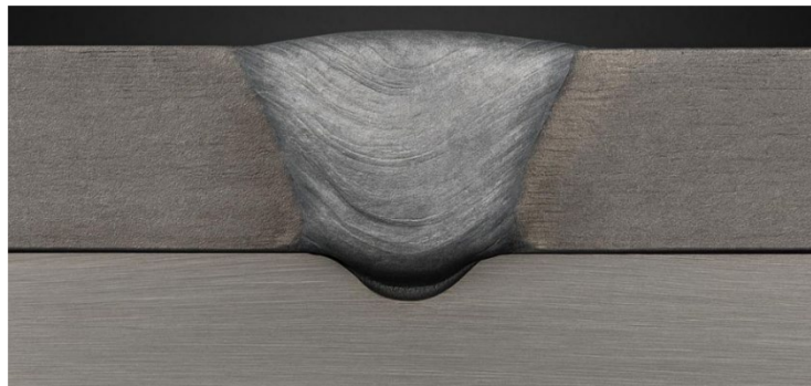
Slika 4: Nezadostna penetracija (Lastni vir)
