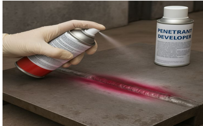
Slika 18: Penetracijski test (Lastni vir)
