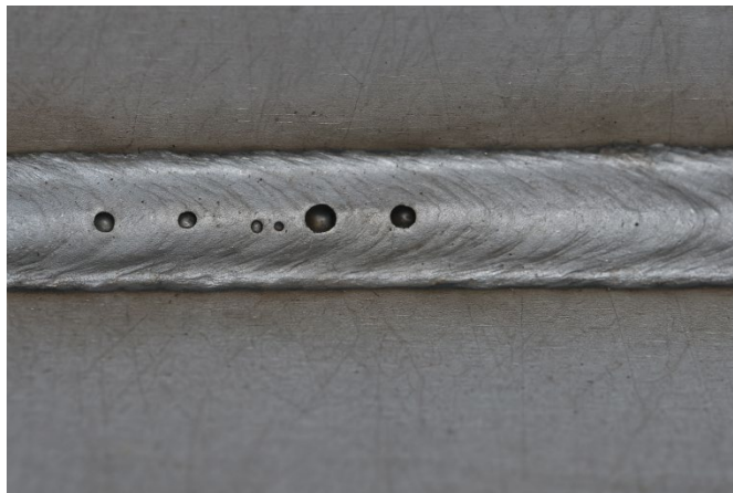
Slika 2: Poroznost (Lastni vir)
