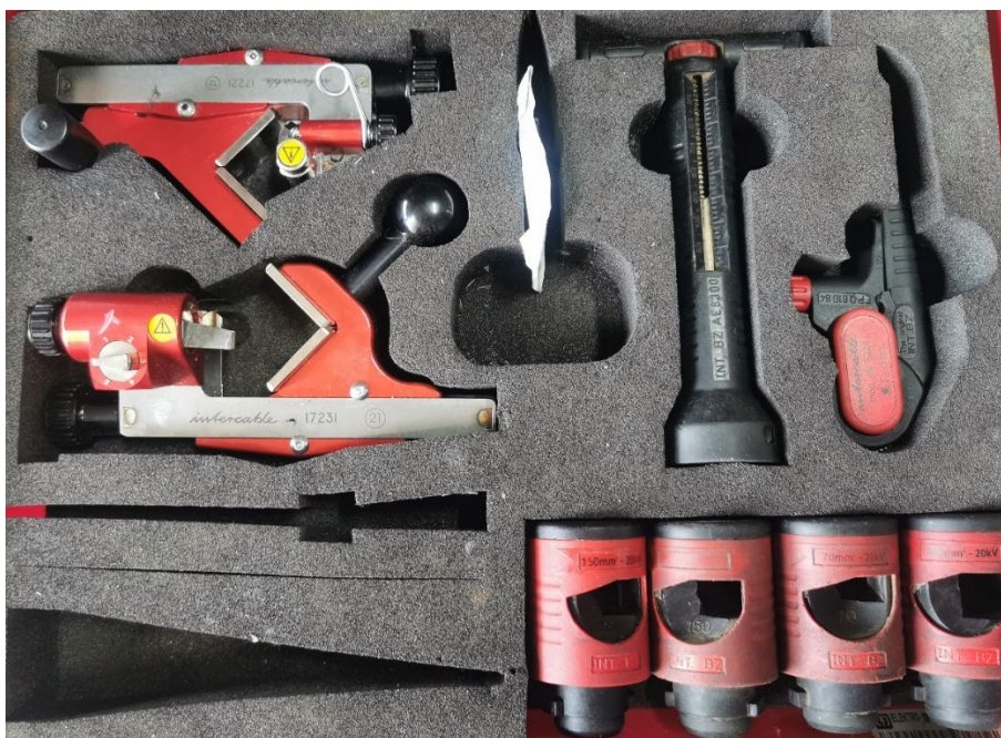
Slika 12: Set orodja za obdelavo kablskih koncev proizvajalca Intercable (Lastni vir)
