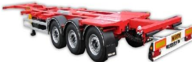
Slika 24: Raztegljiva prikolica za prevoz 20, 30, 40 in 45" kontejnerjev
