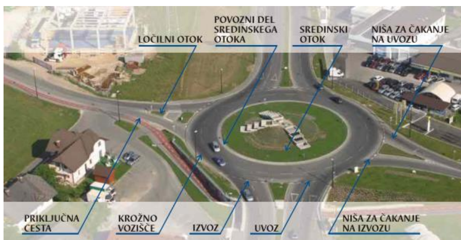
Slika 1: Elementi krožnega križišča
