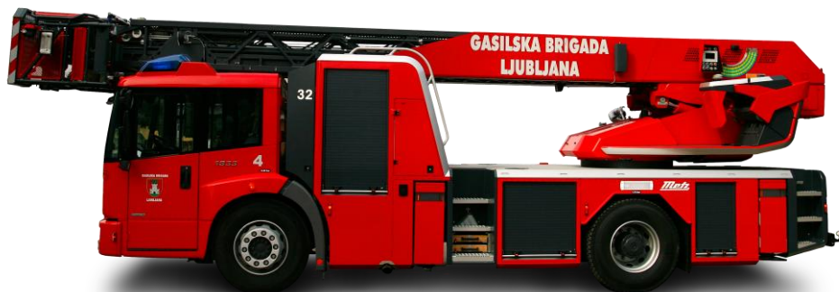
Slika 23: Najnovejše gasilsko vozilo – lestev Metz Aerials (Vir: Gasilska brigada Ljubljana)
