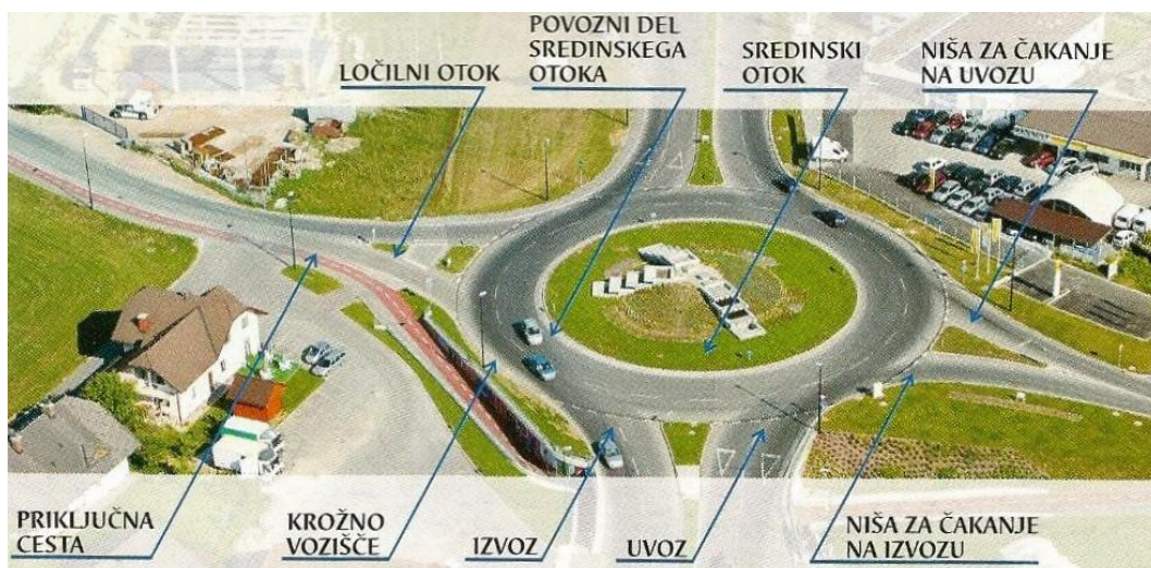
Slika 2: Elementi krožnega križišča (Vir: Tollazzi, 2006)
