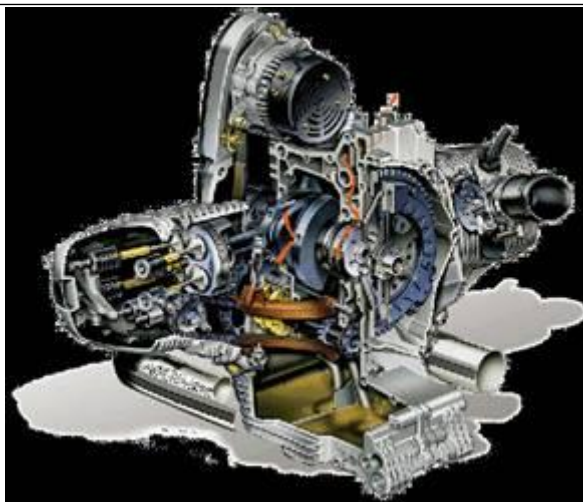
Slika 35: Prerez boksarskega motorja R 1150 RT (vir: www.ketchum.org , 2010)
