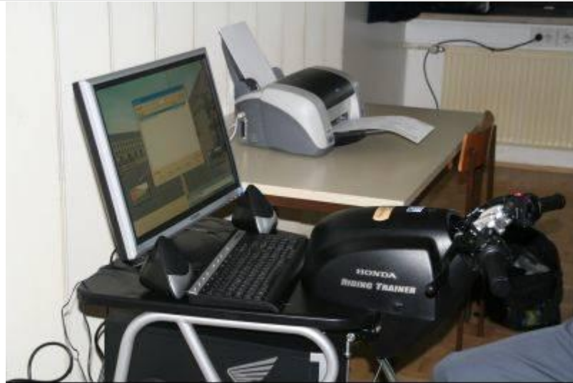
Slika 32: Simulator za usposabljanje v varni vožnji motornega kolesa Honda Riding Trainer RT1 (vir: www.policija.si , 2010)
