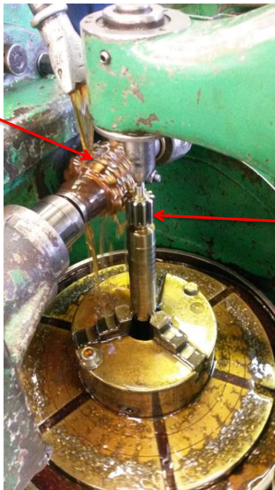
Slika 13: Izdelovanje zobnika na stroju (Vir: Lasten)
