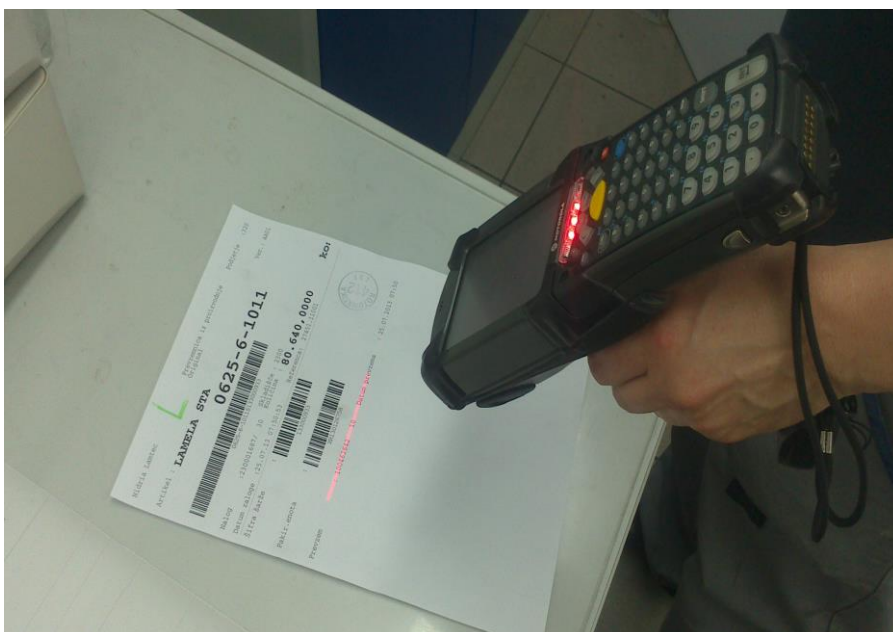
Slika 4: Primer odčitavanja kode s čitalcem, s katerim sistem direktno najde program za izdelavo tega obdelovanca (Vir: osebni arhiv)
