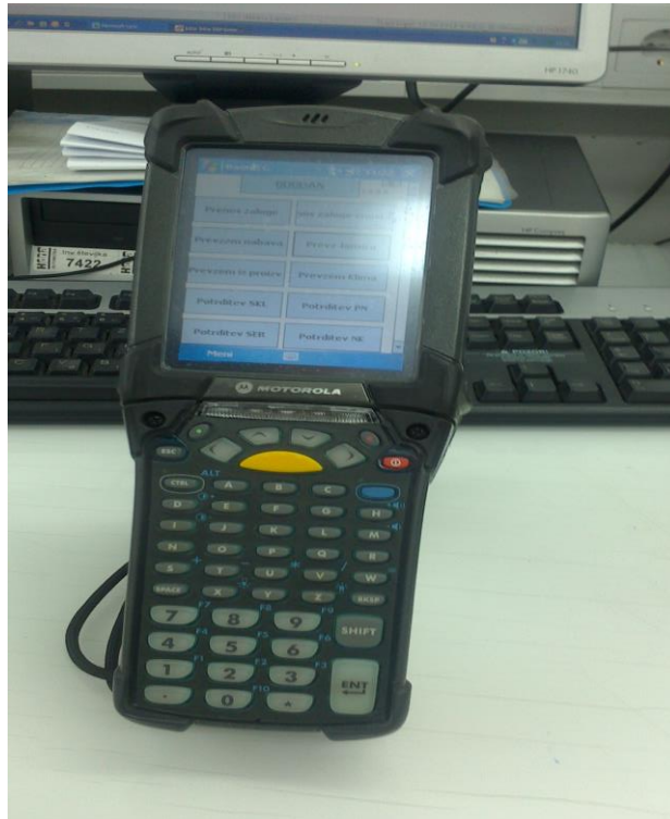
Slika 3: Primer odčitavanja kode s čitalcem, s katerim sistem direktno najde program za izdelavo tega obdelovanca (Vir: osebni arhiv)
