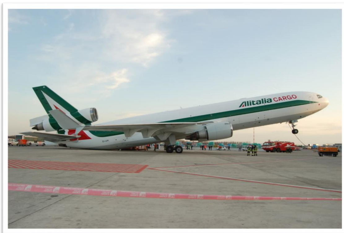
Slika 4: Prikaz posledice nepravilnega tovorjenja letala – »tail tipping«
