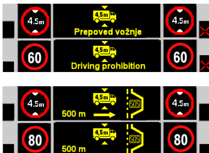
Slika 11: Portal s kontrolo višine pred predorom Šentvid smer Kranj (Dars, 2010)
