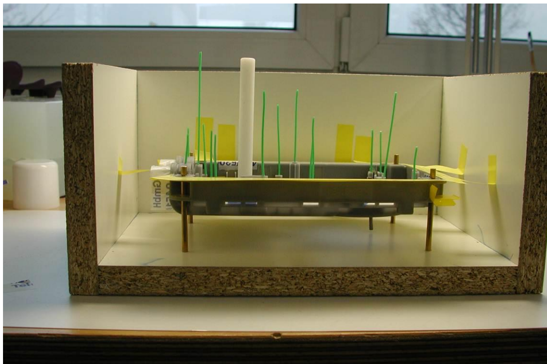
Slika 3: Pramodel, pripravljen za ulivanje silikona
