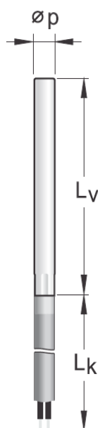
Slika 5: Kabelsko tipalo (Vir: Elektronika Pahor d.o.o.)
