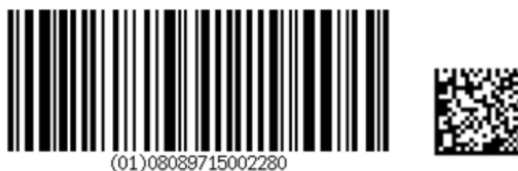
Slika 12: Linearna EAN-14 in podatkovna Matrix črna koda (Vir: Lasten)
