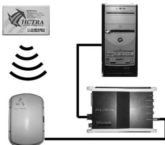
Slika 15: Povezovanje komponent RFID sistema (Vir: Jones, Chung, 2011)
