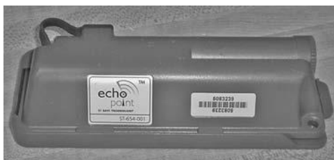
Slika 28: Aktivni tag za uporabo na kontejnerjih, dimenzij 16 x 5 x 3 cm (Vir: Jones, Chung, 2011)
