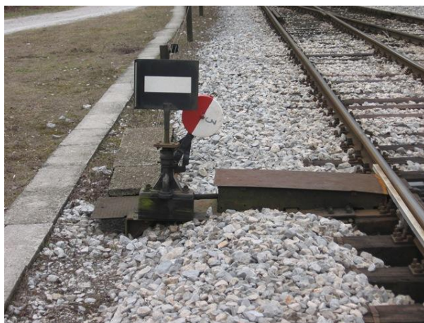
Slika 19: Kretniški nastavek na Postaji Most na Soči Vir: Lastno gradivo, Goran Jungič
