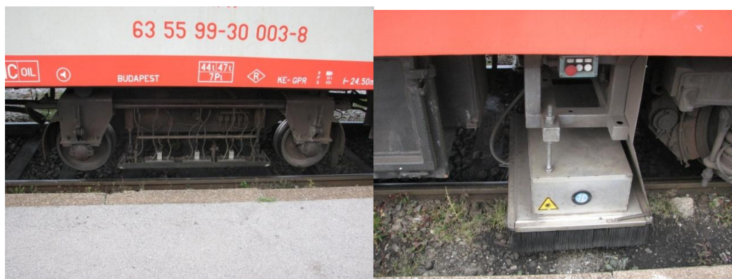
Slika 24: Merilna kolesca ter naprava za pregled tirnic
