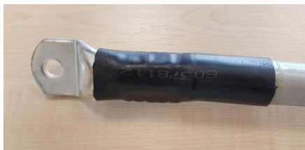
Slika 30: Primer spoja med kabel čevljem in vodnikom (Vir: Lasten)
