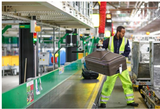
Slika 13: Primer uporabe vakuumskega manipulatorja (Vir: https://www.airport-suppliers.com/supplier/vaculex/ , 2017)
