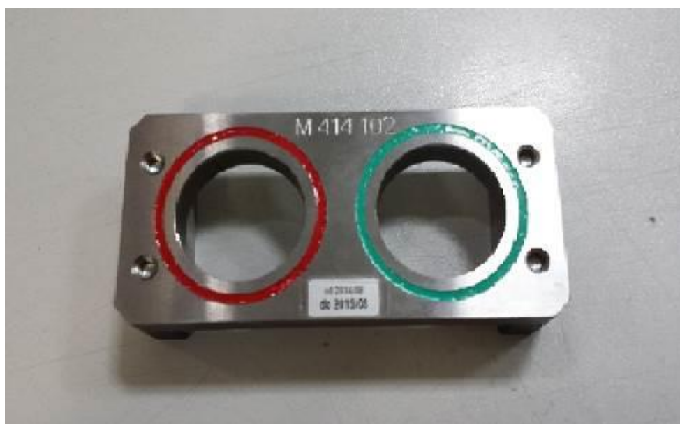
Slika 18: Primer Poka Yoke (NOK/OK) (Vir: interno gradivo)
