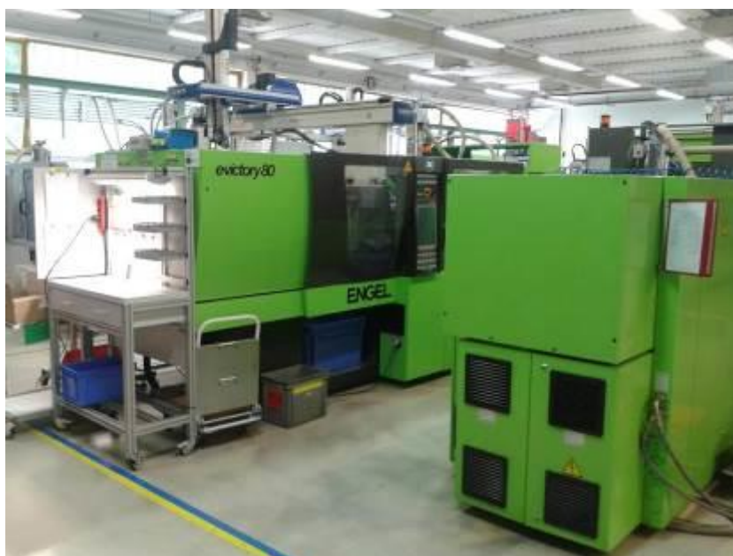
Slika 5: Brizgalni stroji Engel (Vir: interno gradivo)
