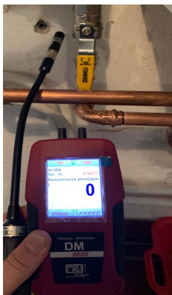
Slika 31: Preverjanje tesnosti plinske povezave (Lastni vir)
