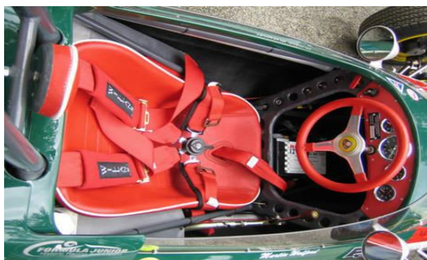
Slika 8: Pettočkovni varnostni pas (Vir: http://en.wikipedia.org )
