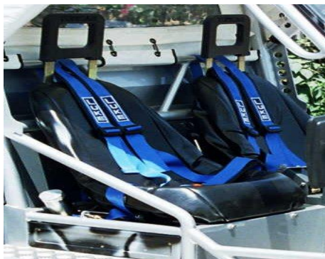
Slika 9: Šesttočkovni varnostni pas (Vir: http://en.wikipedia.org )
