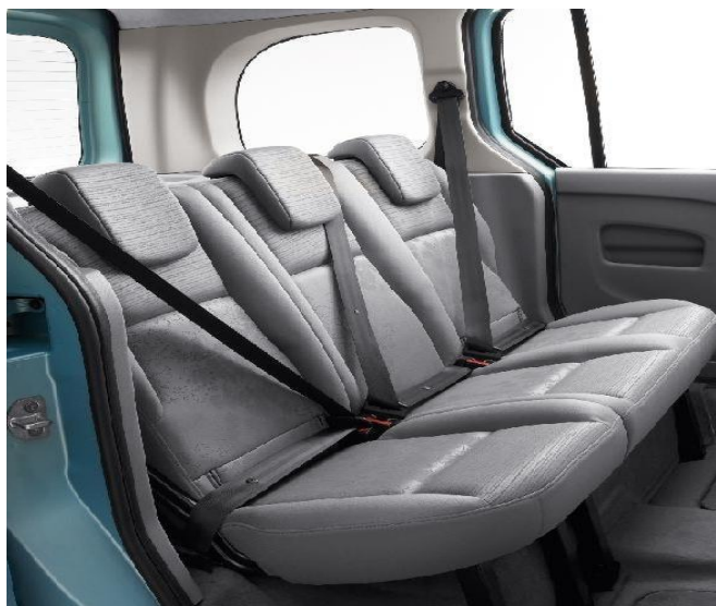
Slika 6: Tritočkovni varnostni pas (Vir: http://en.wikipedia.org )
