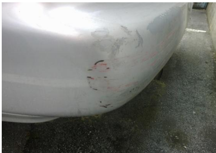
Slika 8: Sled laka na vozilu Vir: Lastni
