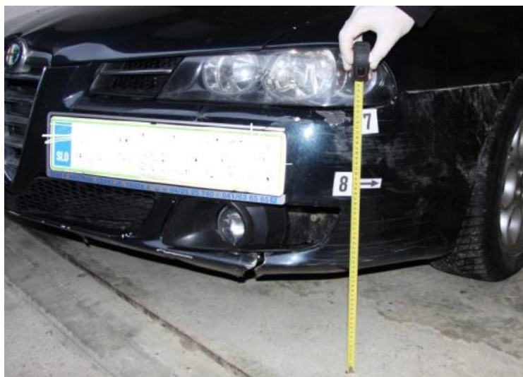
Slika 2: Označitev sledi na vozilu Vir: Lastni
