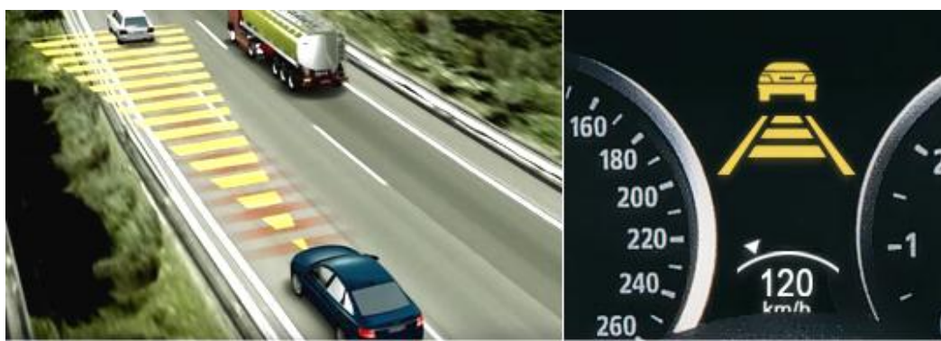
Slika 6: Prikaz delovanja aktivnega tempomata (Vir: spletni portal Bosch)
