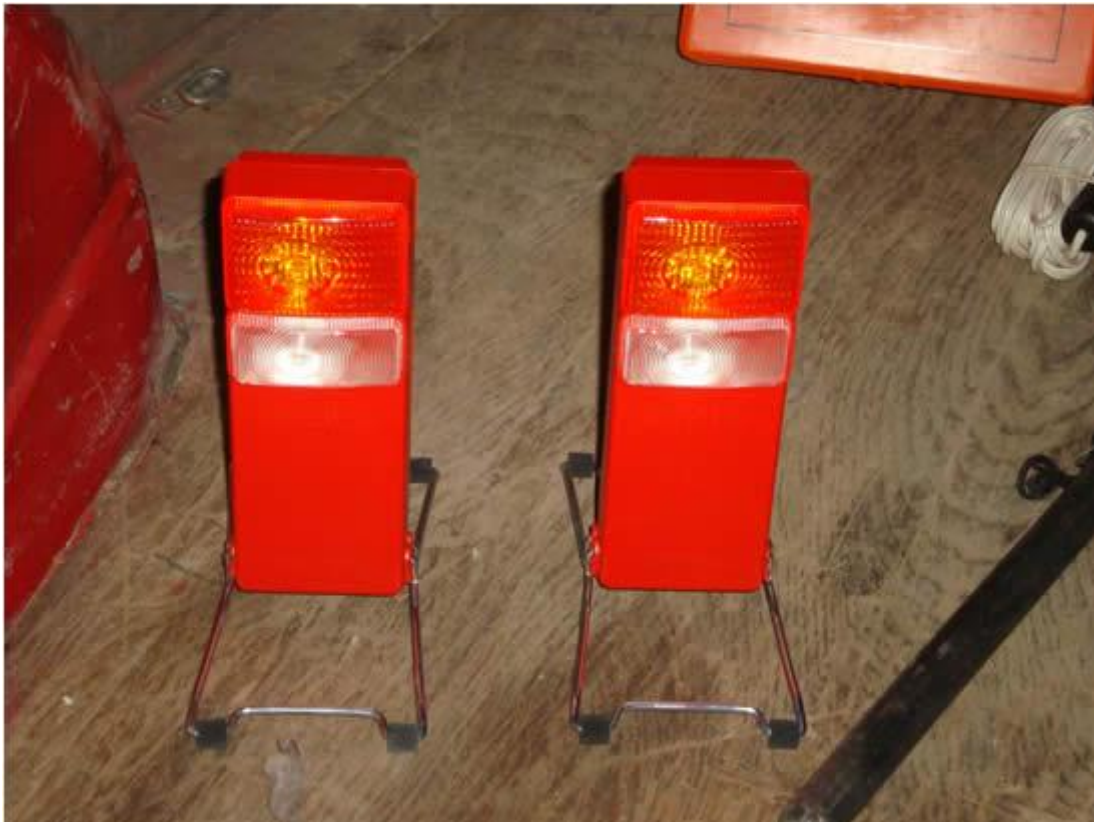
Slika 2: Svetilke brez iskrivih delov (vir: lasten)
