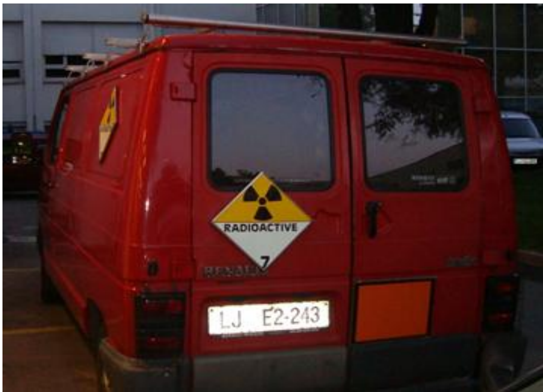
Slika 4: Vozilo s tablo nevarnosti in oranžno tablo (vir: lasten)
