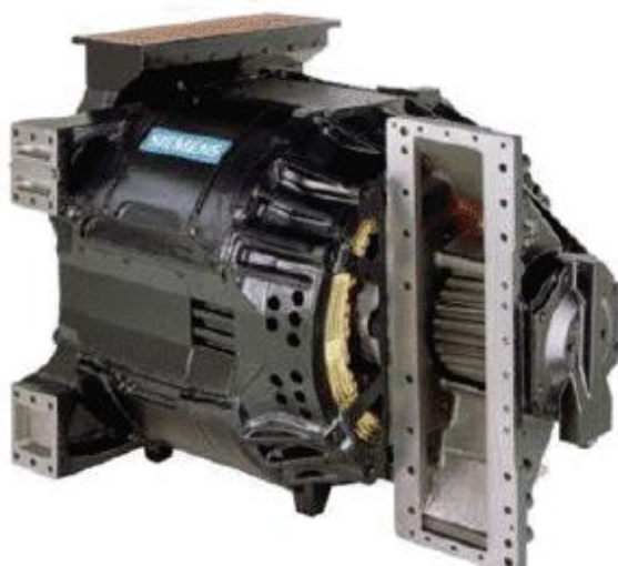
Slika 13: Sodoben električni vlečni asinhronski motor električne lokomotive 541 (Vir: Arhiv Holding Slovenske železnice, d.o.o)
