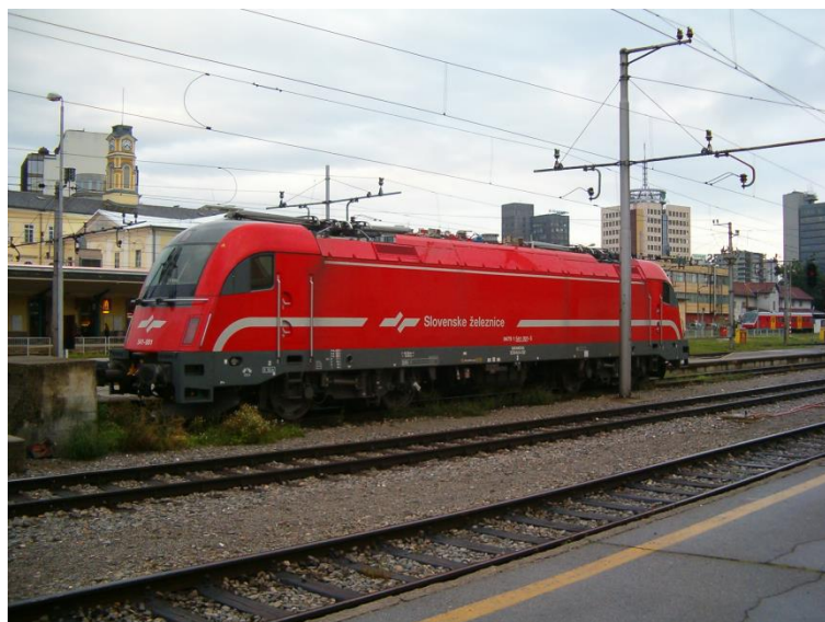
Slika 14: Večsistemska električna lokomotiva serije 541 (VIR: http://vlaki.miniaturna-zeleznica.com/ )
