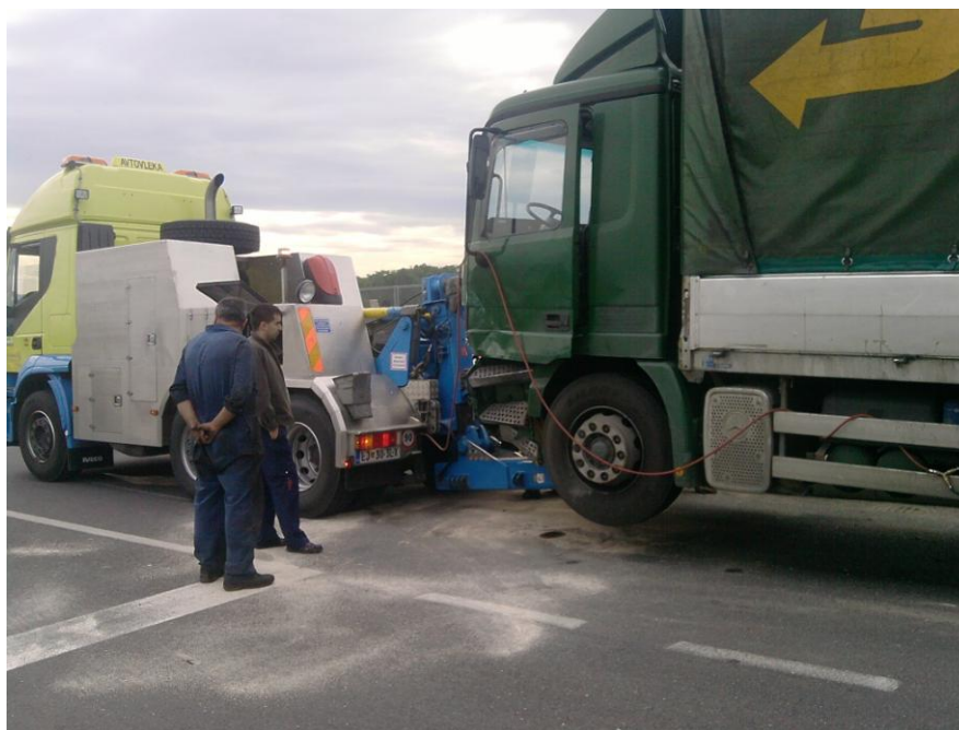
Slika 3: Primer 3 osnega vlečnega vozila, vleka pokvarjenega polno natovorjenega tovornjaka skupne mase 40 ton (Vir: Lastna fotografija)
