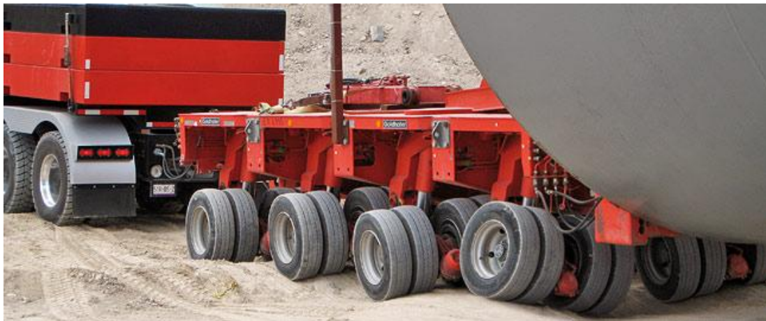
Slika 4: Primer prilagajanja hidravlike koles priklopnega vozila (Vir: http://www.goldhofer.de/gh-en/modular-vehicles/introduction-to-the-technology.php )
