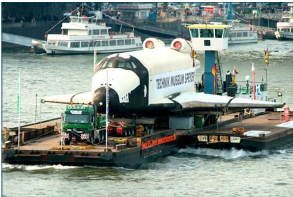
Slika 22: Izredni prevoz raketoplana »Buran« v Tehnični muzej Speyer s kombinacijo rečnega transporta (RO-RO) in cestnega transporta, vir: avtor
