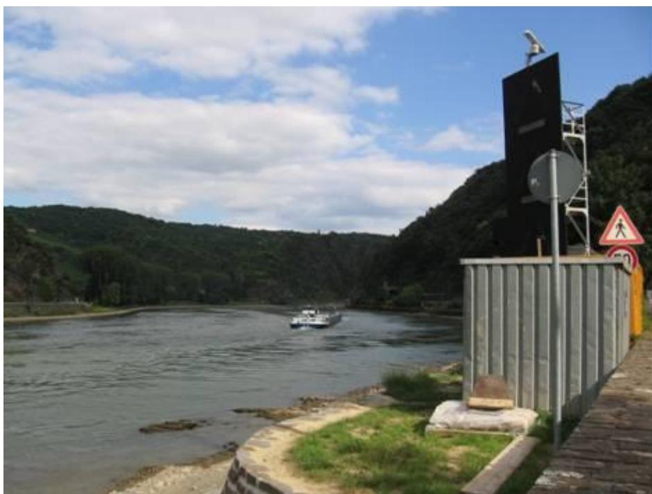
Slika 16: Postavitev radarsko vodenega semaforja ob vstopu v dolino Loreley na Renu, vir: avtor
