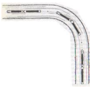
Slika 3: Zavijanje potiskane barže v rečnem zavoju, vir: Schönknecht, R. in Gewiese, A. (1988) – izbrana poglavja. Auf Flüssen und Kanälen: Die Binnenschifffahrt der Welt , str. 102, Steiger, Moers, Nemška demokratična republika (DDR)
