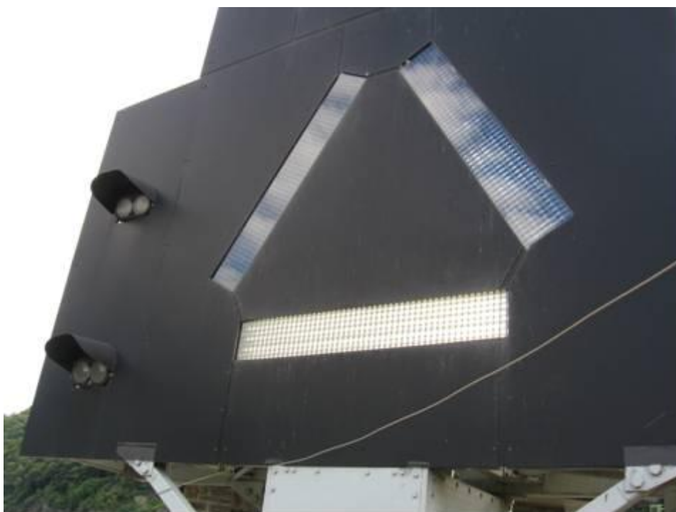
Slika 15: Detajl radarsko vodenega semaforja (trenutni signal kaže, da je pot zaprta), vir: avtor
