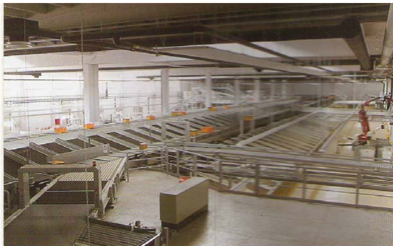
Slika 6: Avtomatski paketni usmerjevalnik v PLC Maribor
