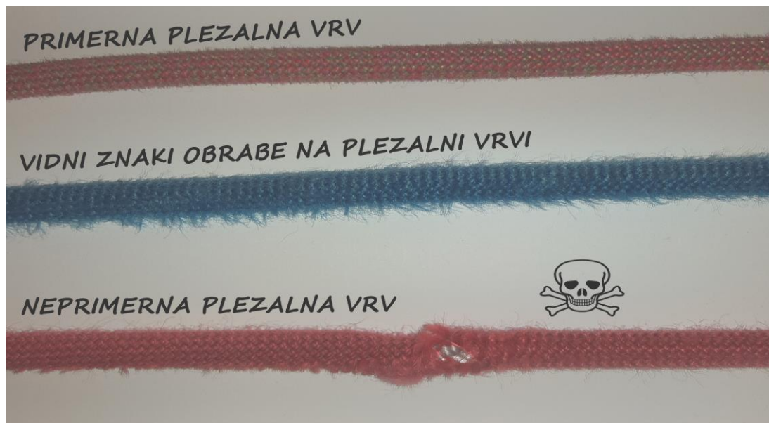
Slika 2: Ključen pripomoček pri plezanju je plezalna vrv, za katero je odgovoren vodja. Slika prikazuje primerno in neprimerno plezalno vrv (Lasten vir)
