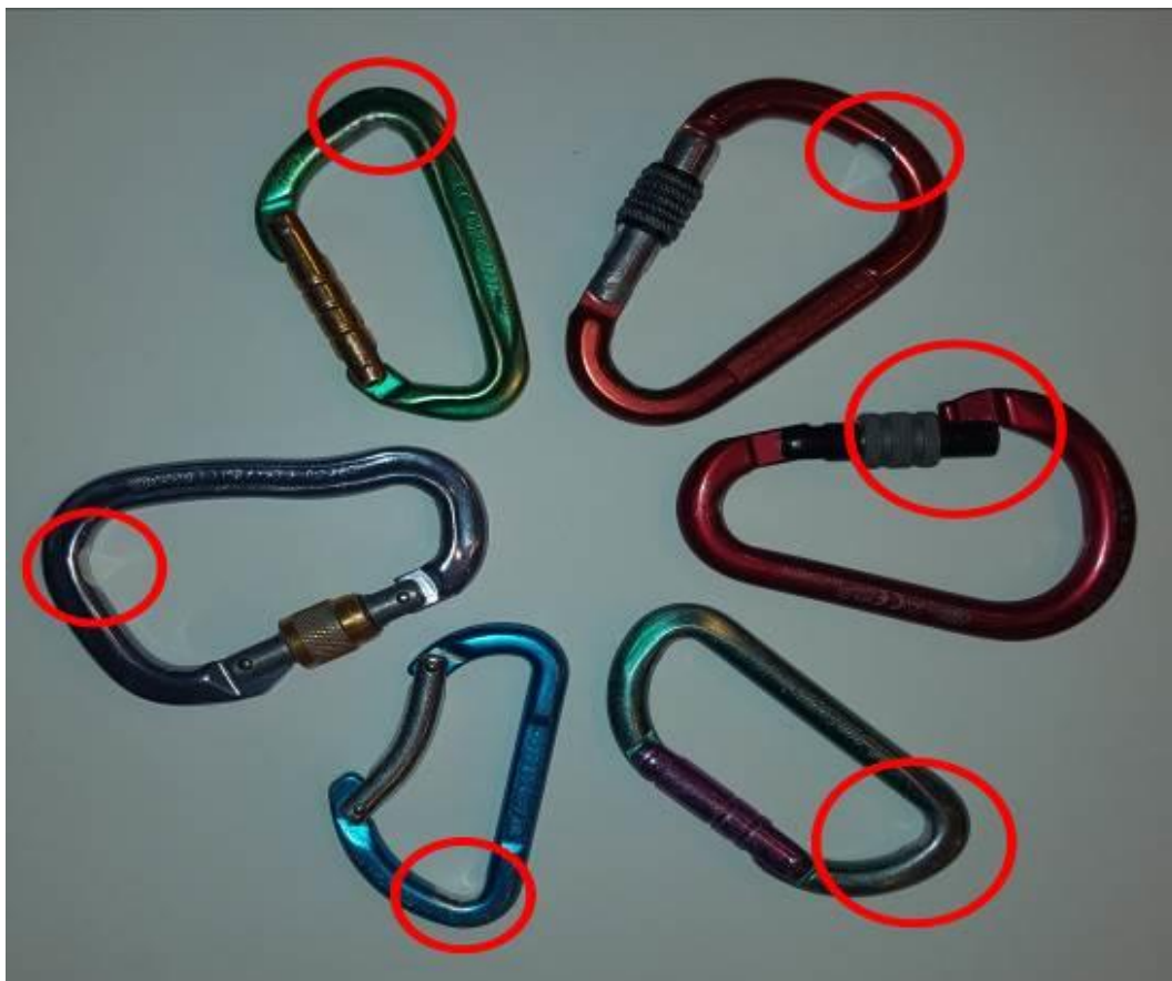
Slika 3: Na označenih mestih dobro vidne poškodbe plezalnih vponk (Lasten vir)
