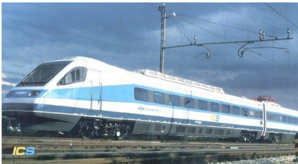
Slika 2: Sodobni vlak z nagibno tehniko serije 310 - Fiat
