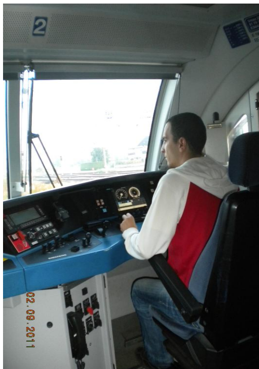
Slika 12: Kontrola varnostnih naprav lokomotive serije 541 VIR: Bojan Kovačević, d.o.o., 2011
