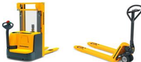
Slika 8: Ročni paletni voziček in električni ročni paletni viličar (Vir: www.jungheinrich.si )
