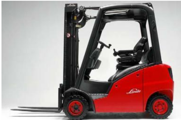
Slika 9: Prikaz viličarja za uporabo nakladanja paletnih pošiljk pri odpremi blaga (Vir: www.linde-vilicar.si , 2012)
