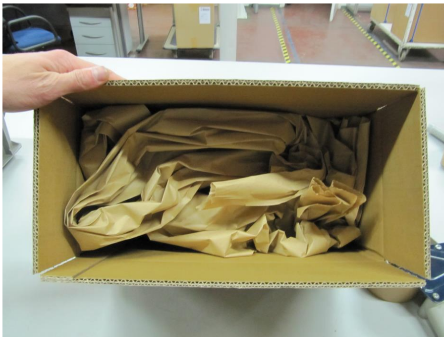
Slika 3: Zaščita izdelkov ali polizdelkov s predpisanim zaščitnim papirjem (Vir: Distribucija blaga, 2011 – Iskra Mehanizmi, d.o.o. )
