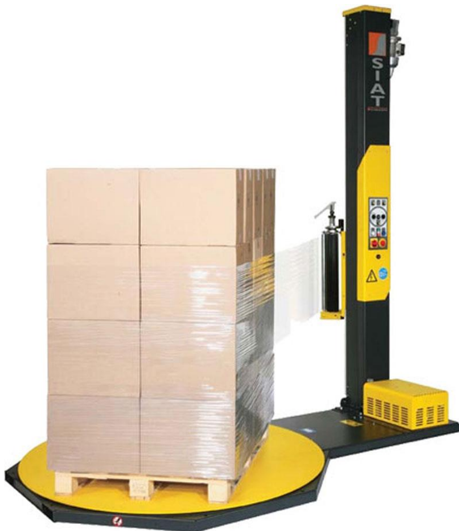
Slika 7: Povijalni mehanizem za povijanje palet večjih pošiljk (Vir: www.logopak.si , 2012)
