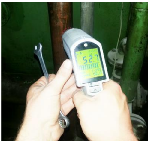
Slika 15: Temperatura olja po hladilniku (Vir: Lastni, 2020)
