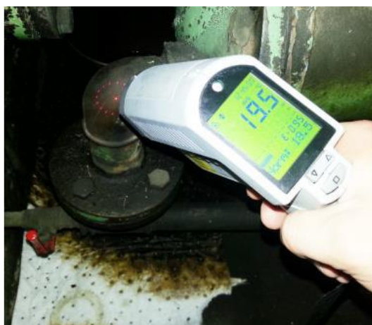
Slika 14: Izstopna temperatura iz izmenjevalca (Vir: Lastni, 2020)
