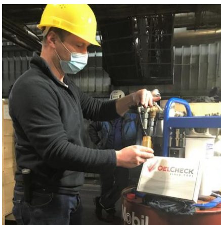
Slika 42: Odvzem vzorca (Vir: Dimas d. o. o., 2020)
