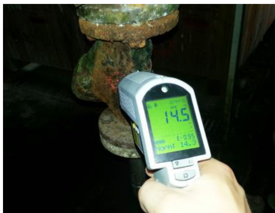
Slika 13: Temperatura hladilne vode v izmenjevalcu (Vir: Lastni, 2020)
