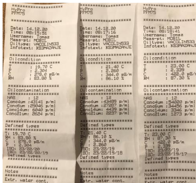
Slika 40: Meritve ISO-kode (Vir: Dimas d. o. o., 2020)
