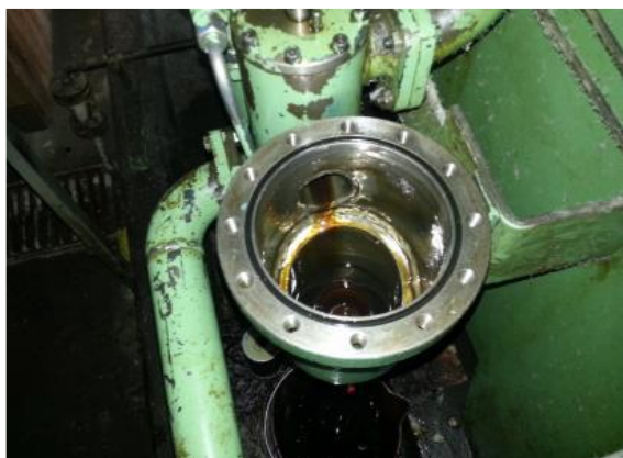
Slika 19: Posoda filtra (Vir: Lastni, 2020)
