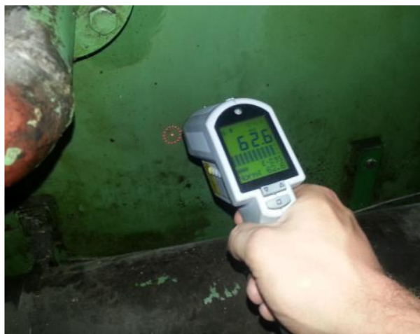
Slika 11: Izmerjena temperatura na steni rezervoarja (Vir: Lastni, 2020)
