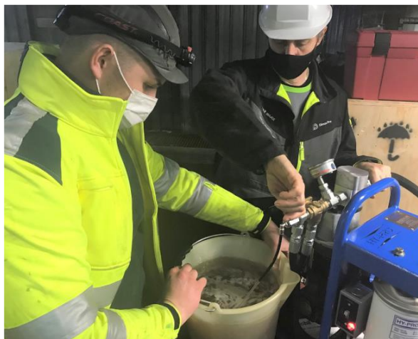
Slika 49: Odstranitev vode iz olja (Vir: Dimas d. o. o., 2020)
