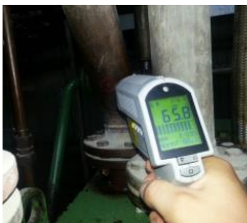
Slika 10: Merjenje temperature – povratna cev 2 (Vir: Lastni, 2020)
