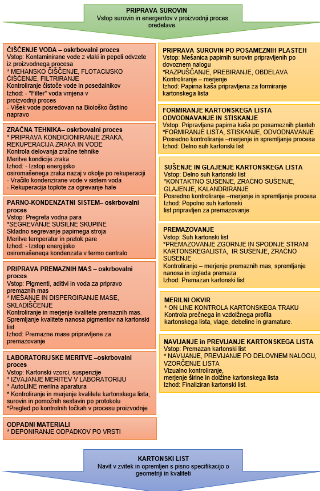
Slika 1: Shematski prikaz, kako nastane kartonski trak (Vir: Interni, Količevo Karton d. o. o., 2015)
