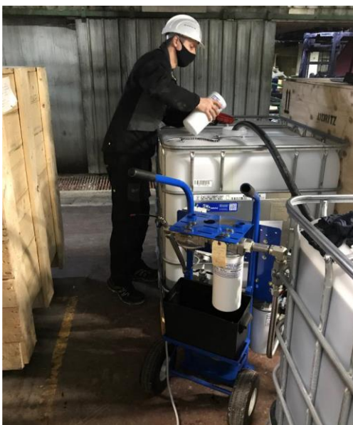
Slika 41: Filtriranje olja v PVC-posodah (Vir: Dimas d. o. o., 2020)
