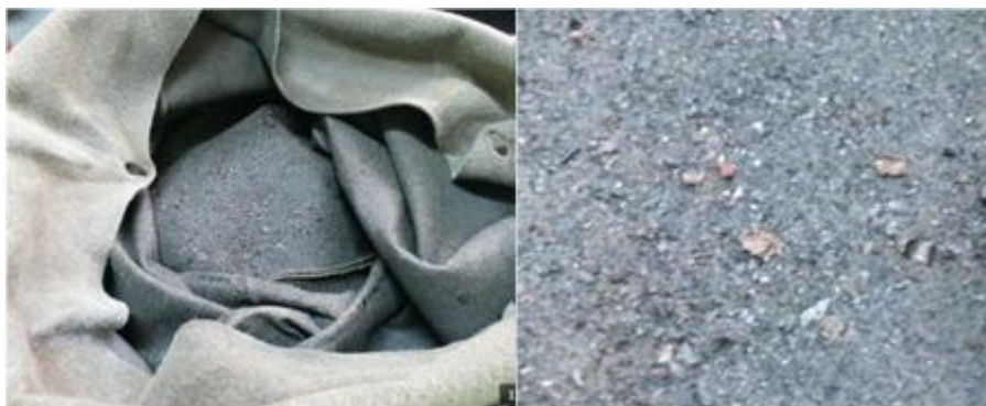
Slika 22: Izgrajena vreča in povečava usedlin (Vir: Lastni, 2020)
