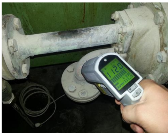
Slika 12: Merjenje temperature na kondenzatni cevi (Vir: Lastni, 2020)
