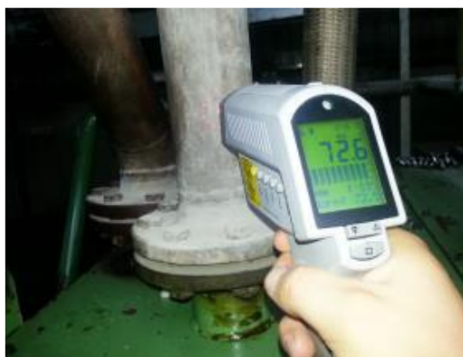
Slika 9: Merjenje temperature – povratna cev 1 (Vir: Lastni, 2020)
