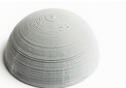
Slika 17: Model polkrogle, natisnjen z materialom PETG
