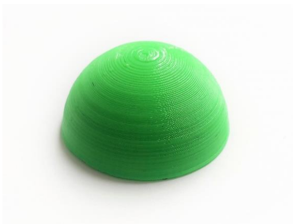
Slika 13: Model polkrogle, natisnjen z materialom PLA (Lastni vir)
