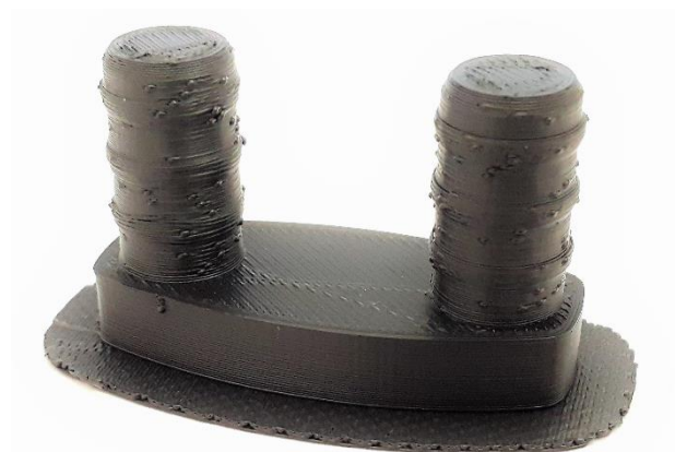
Slika 30: Prototip z dodatno površino za oprijem ( raft ) (Lastni vir)
