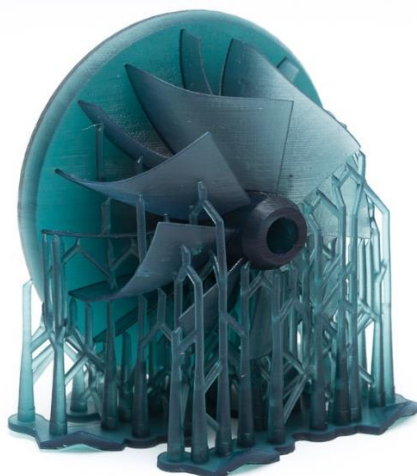
Slika 4: Prikaz podpor pri SLA-tehnologiji (Vir: 3D Hubs, 2018)
