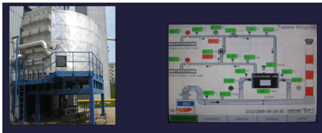
Slika 33: Procesni diagram toplarne Konjarnik (Vir: interni vir podjetja Toplarna Konjarnik)
