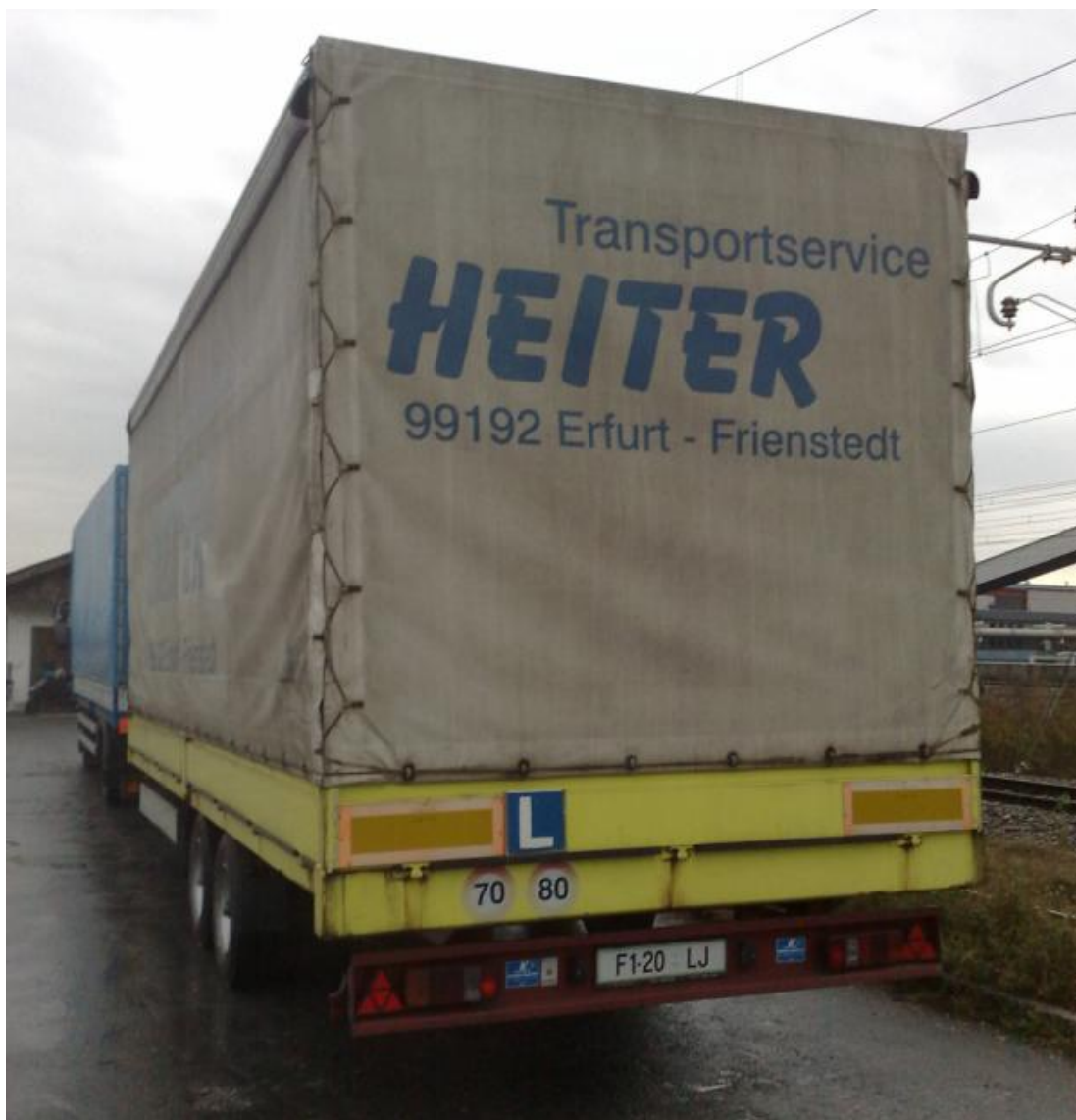
Slika 8: Poravnava vlečnega vozila v linijo z vlečenim vozilom pred priklopom (Vir: lastni)
