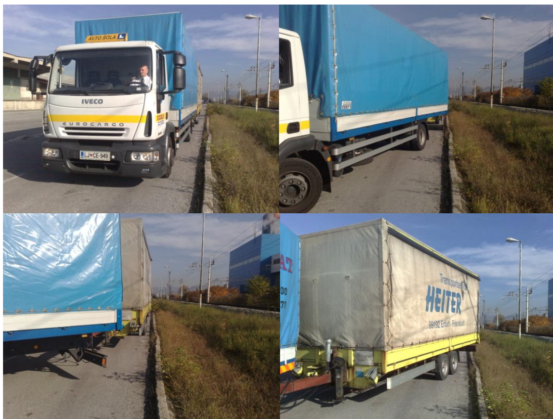
Slika 3: Prikaz odmika previsa za zadnjim kolesom vlečnega in vlečenega vozila pri obračanju v desno (Vir: lastni)
