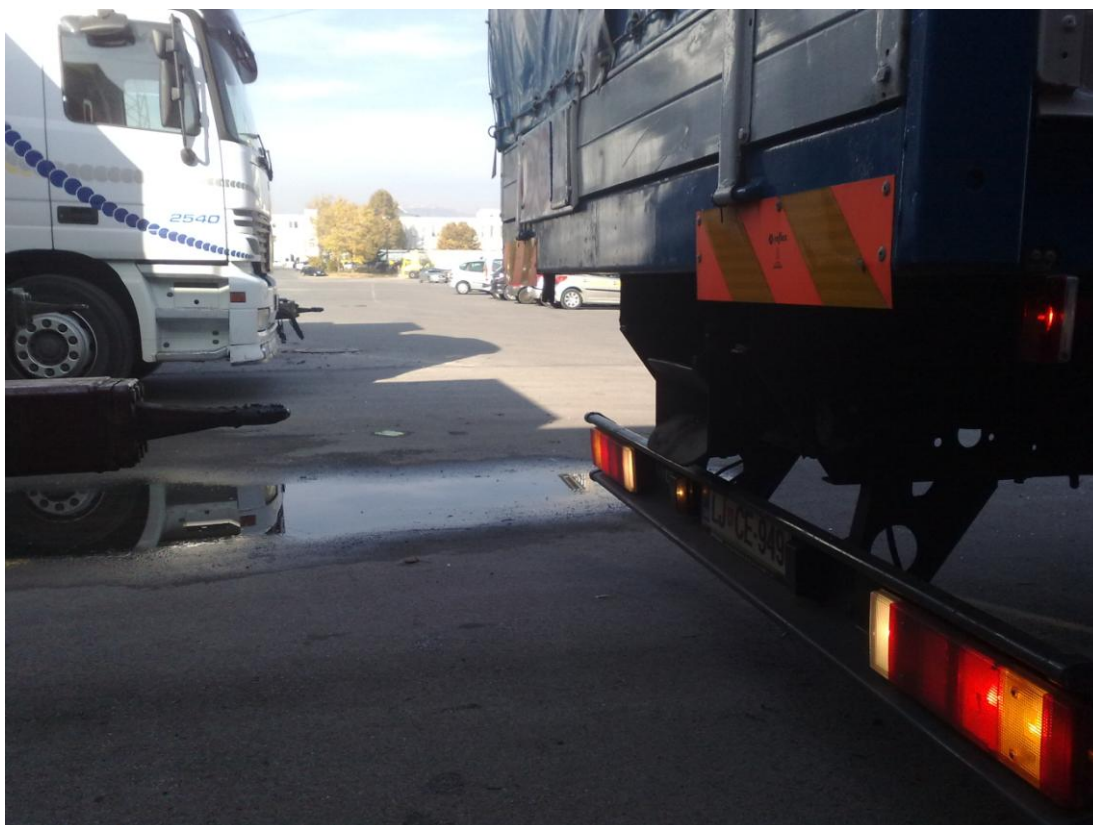
Slika 7: Približanje vlečnega vozila na približno en meter do priklopnika (Vir: lastni)
