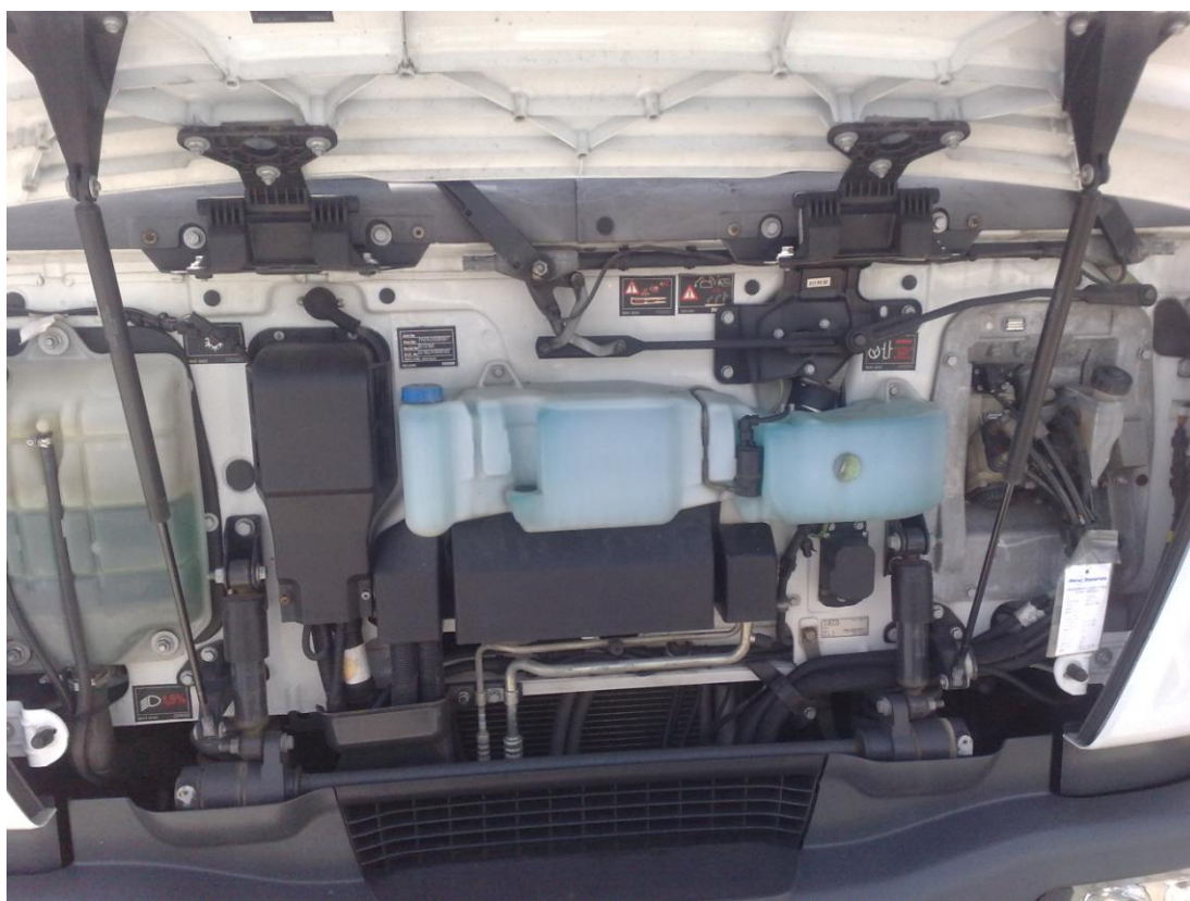
Slika 2: Kontrola tekočin pred pričetkom vožnje (Vir: lastni)
