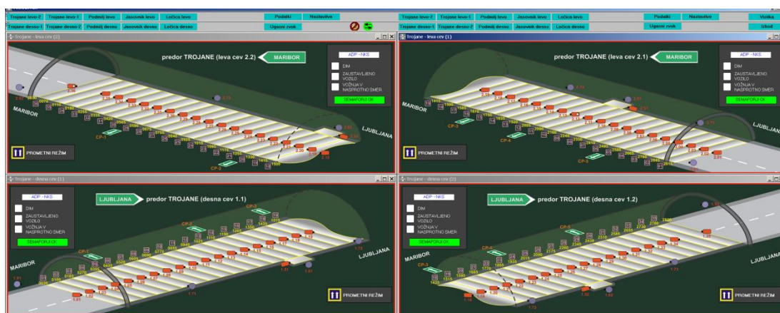
Slika 12: Sistem za avtomatsko detekcijo prometa v RNC Vransko, prikaz za predor Trojane (Vir: Nadzorni center Vransko, Dars d. d.)
