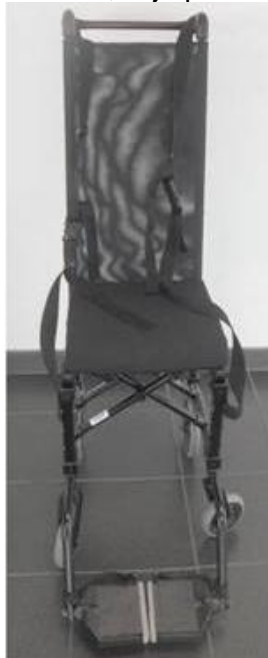
Slika 12: Poseben stol primeren za transport PRM-potnika v letalu (Vir: lasten, 2011)
