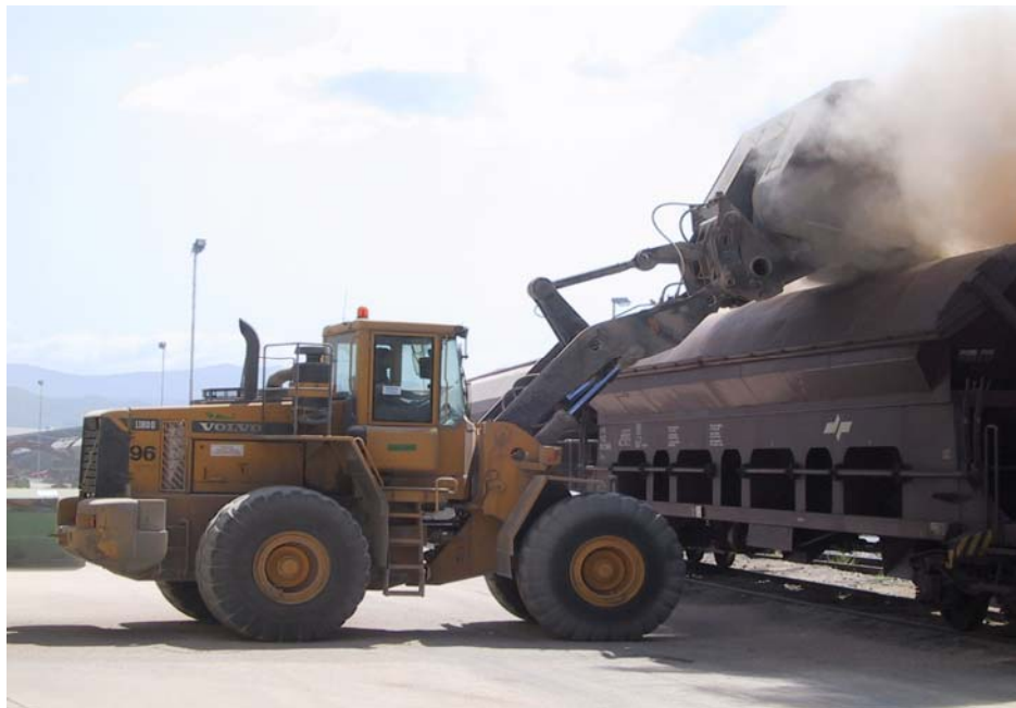
Slika 15 : Klasično nakladanje vagonov(vir: avtor)
