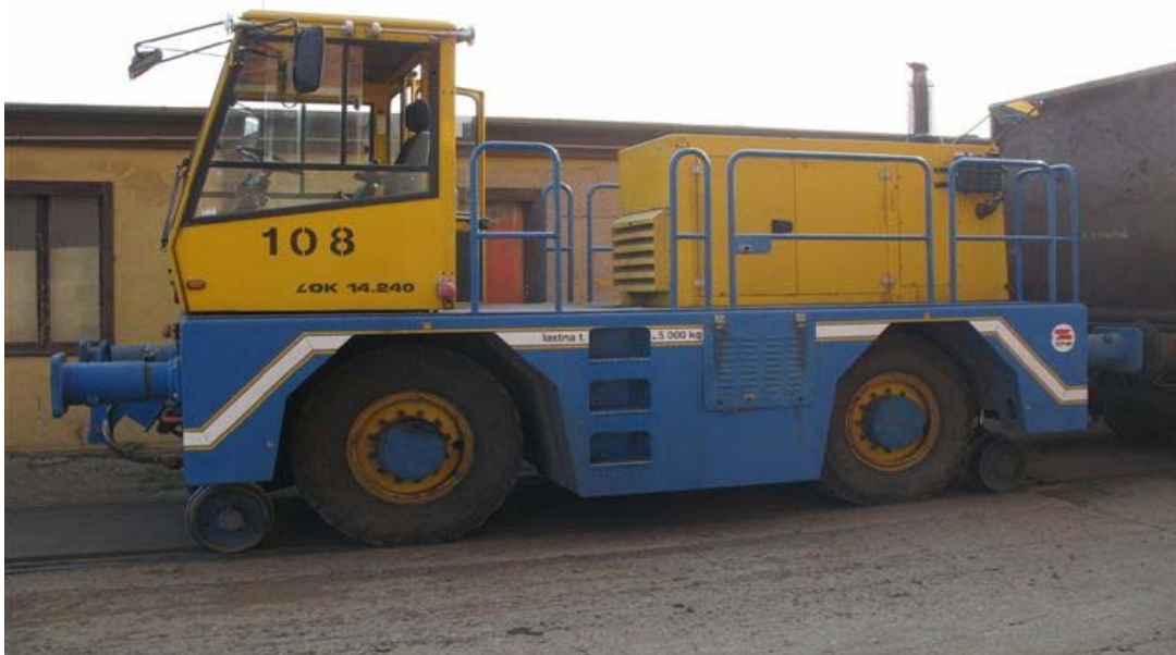
Slika 17: Cestno tirno vlečno vozilo Zephir (vir: avtor)
