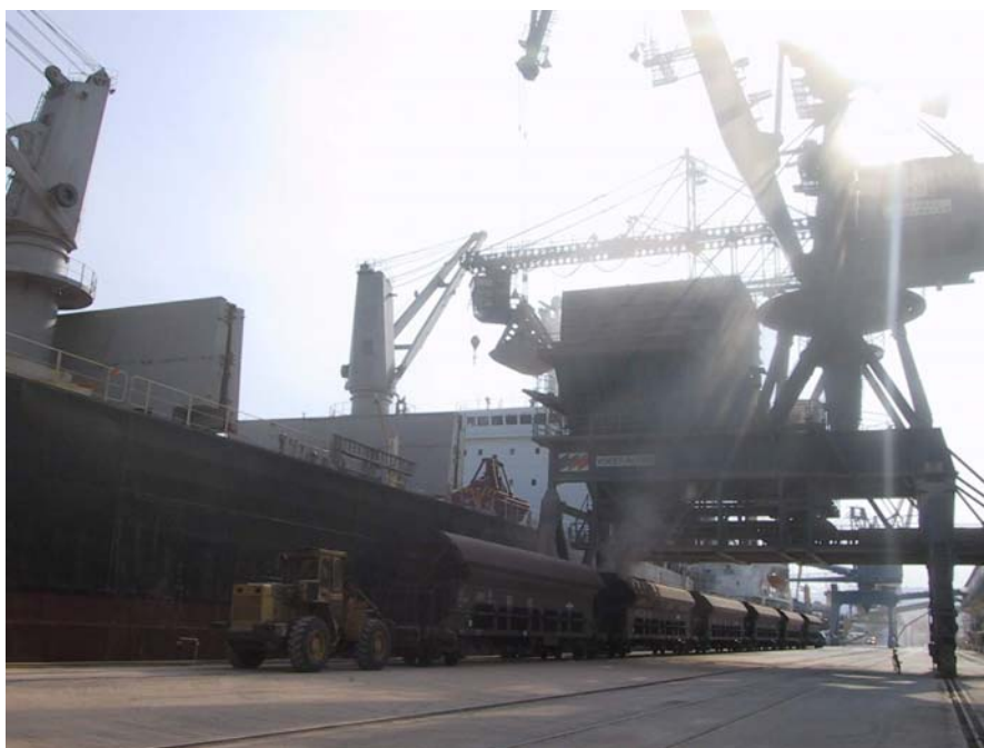
Slika 14: Prekladanje fosfatov iz ladje v vagonne s pomočjo Kenguru žerjave
