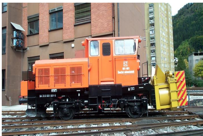
Slika 48: Snežni odmetalnik BEILHACK – SŽ 999-001 VIR: SŽ; Infrastruktura, 2010
