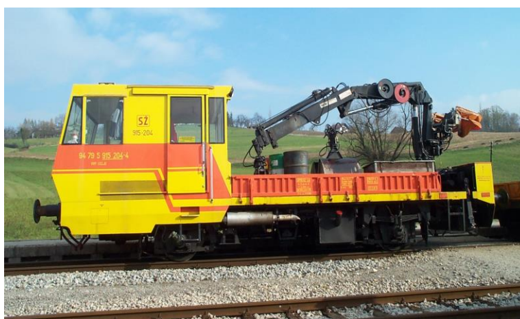
Slika 44: TMD 915 z dvigalom – za vzdrževanje proge VIR: SŽ; Infrastruktura, 2010
