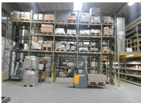
Slika 10: Regali s podestom v odpremni skladišču (Lastni vir)
