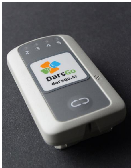
Slika 2: Naprava za elektronsko cestninjenja DarsGo (Vir: DARS, 2019)
