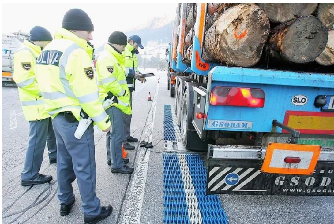
Slika 9: Mobilno tehtanje tovornega vozila (Vir: Gorenjski glas, 2011)
