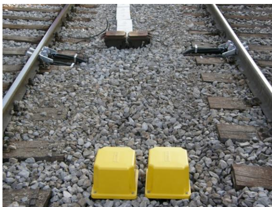
Slika 23: Elektronski kontakt števca osi EKŠO (Vir: http://www.shrani.si/f/1S/sB/11hyI9N/p8200891.jpg )
