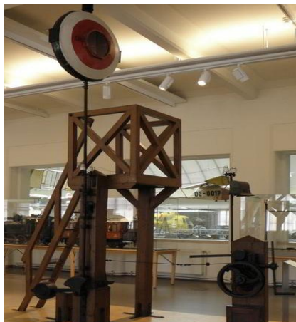
Slika 6: Mehanski signal – posluževanje na samem mestu (Vir: http://fredriks.de/mb/TMW_Signale_2.jpg )
