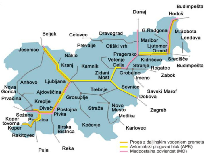
Slika 26: Opremljenost prog z APB, MO in z daljinskim vodenjem prometa (Vir: PE Infrastruktura Služba za električno dejavnost, Pokritost prog s SV napravami, Ljubljana 2010)
