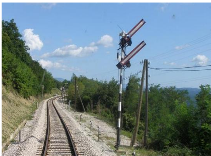
Slika 9: Likovni signal s sistemom z daljinskim posluževanjem (žicevodom) (Vir: http://www.shrani.si/f/1F/oc/10yQTWHk/tomaz-vlaki14podgorska-p.jpg )
