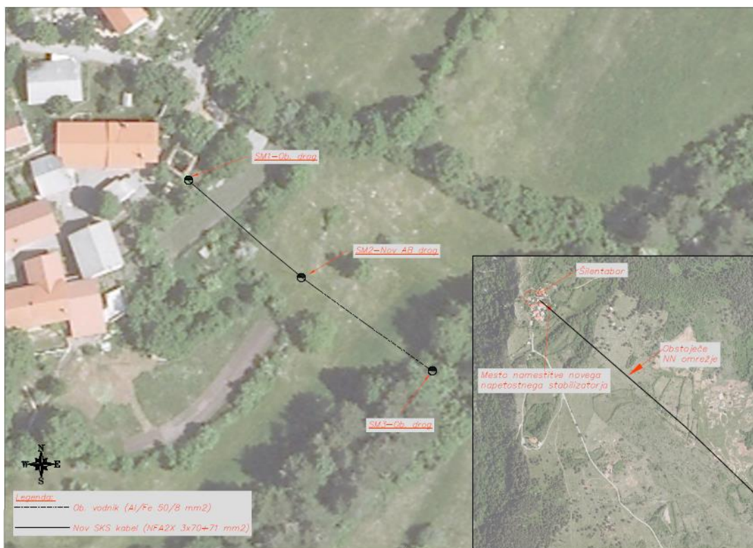
Slika 11: Lokacija postavitve napetostnega stabilizatorja – Šilentabor (Vir: Elektro Primorska, d. d., 2015)
