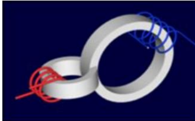
Slika 3: Avtotransformator z dvema pravokotnima magnetnima poljema (Vir: Altens, d. o. o., 2016, str. 1)
