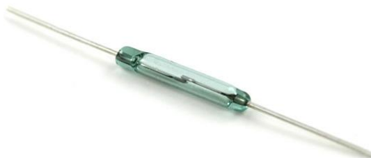
Slika 19: Reedovo stikalo (Vir: Sparkfun, 2017)
