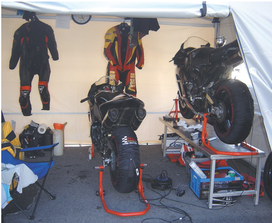
Slika 19: Grelci gum na dirkališču Grobnik (Reka, Hrvaška) Vir: fotografija avtorja
