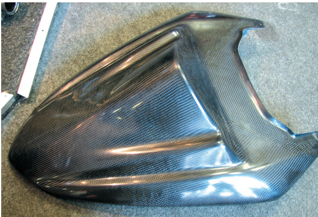
Slika 21: Zadek motornega kolesa iz ogljika Vir: fotografija avtorja
