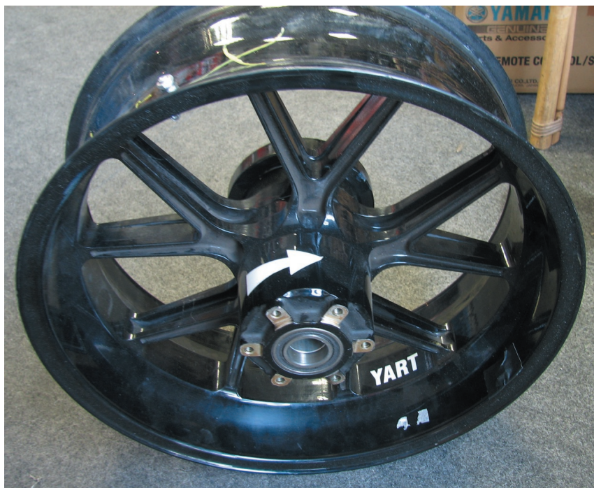
Slika 16: Zadnje platišče (material: kovan magnezij) Vir: fotografija avtorja
