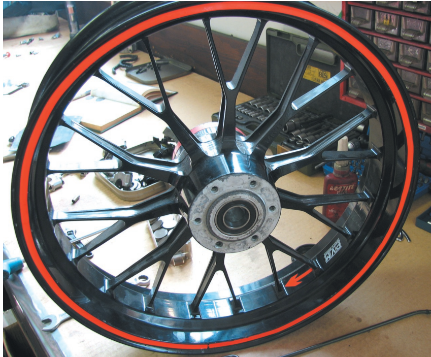
Slika 15: Sprednje platišče (material: kovan magnezij) Vir: fotografija avtorja
