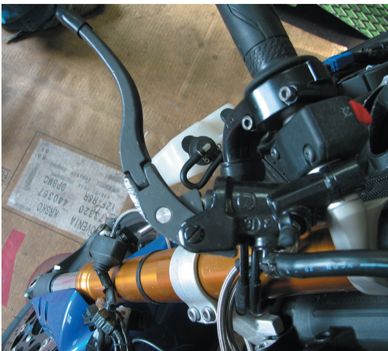
Slika 22: Tekmovalna ročica zavore Vir: fotografija avtorja
