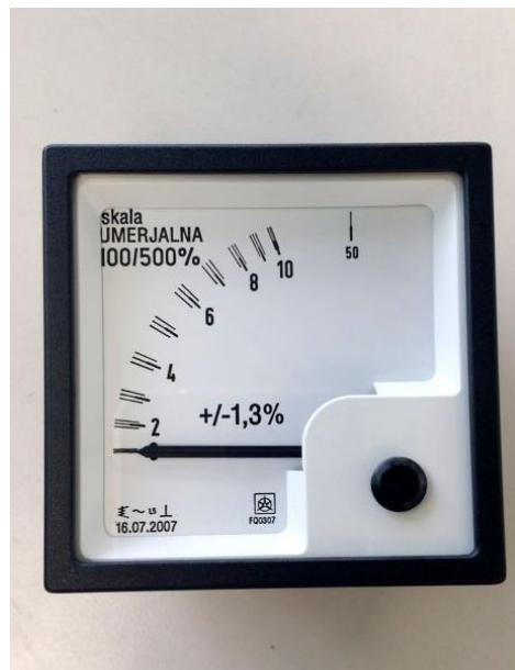
Slika 6: Merilnik z vrtljivim železom FQ 0307 (Lastni vir)
